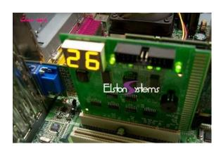
بعض بطاقات POST Card تكون مجهزة أيضا لاختبار الفولتات الأساسية التي تحتاجها الدوائر الالكترونية للوحة الأم حتى يمكنها العمل بصورة سليمة. وتقتصر مثل هذه الاختبارات على وجود أو عدم وجود الفولت المقصود، ويستعان بمجموعة من الثنائيات المضيئة LEDs لبيان نتائج هذه الاختبارات.
